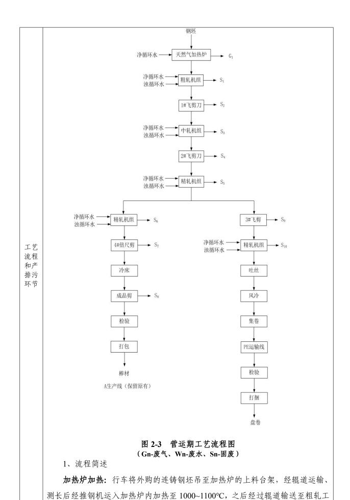
段。该过程使用净循环水对加热炉冷却,由于循环水循环使用,不外排。过程会产生天然气燃烧废气(SO<sub>2</sub>、NO<sub>2</sub>、烟尘)G<sub>1</sub>。
