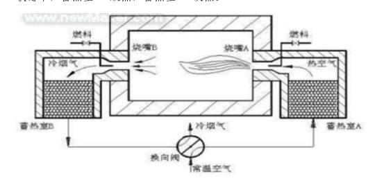
图 2-2 加热炉工作原理图
