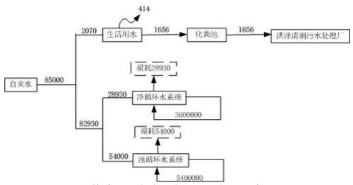
图 2-1 本技改项目实施后全厂水平衡图 (单位 m³/a)
